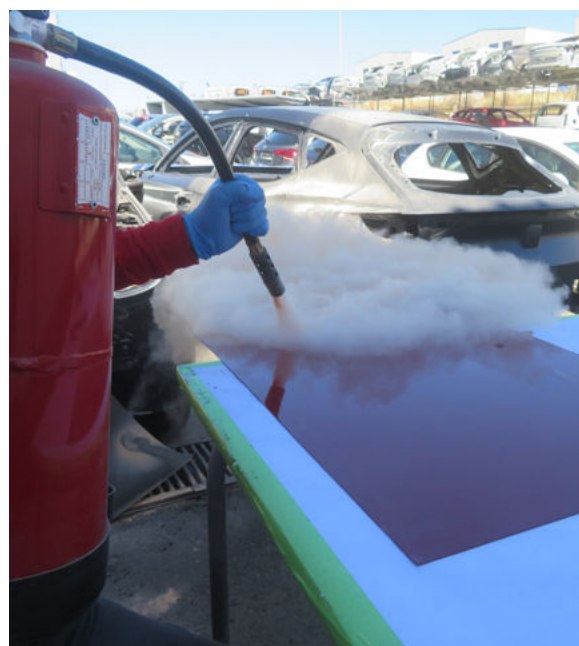
Imagen 4: Ensayo con polvo de extinción de incendios
