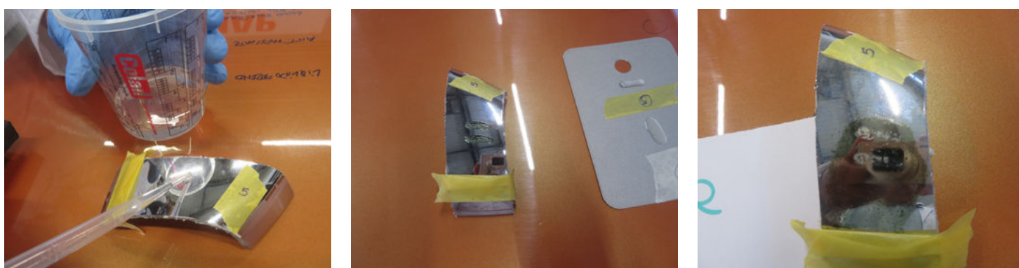
Imagen 12: Cromado deteriorado por ácido clorhídrico
