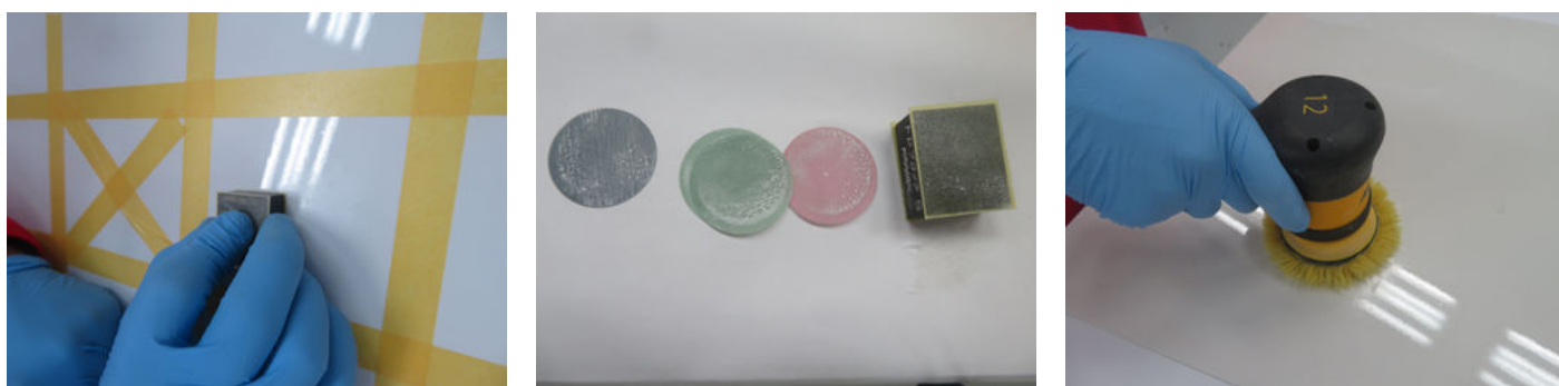
Imagen 10: Determinación de la profundidad del daño
