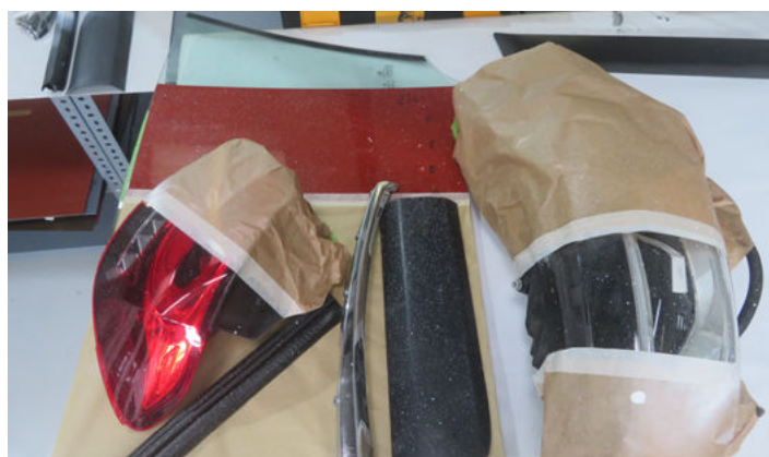
Imagen 5: Superficies alcanzadas por proyección de pintura de fachadas
