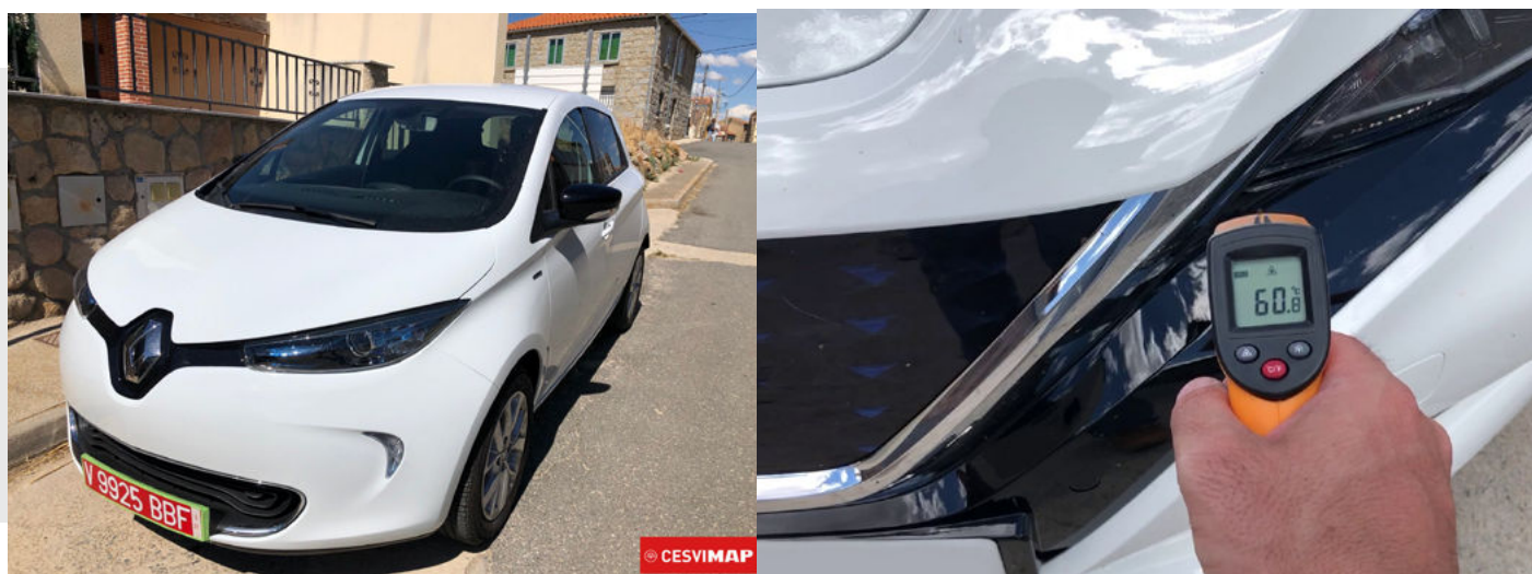
Ilustración 18 y 19: Registro de temperatura con termómetro de infrarrojos
