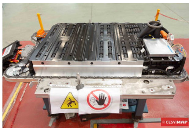
Ilustración 4: Batería de alta tensión de un Renault ZOE, desmontada
