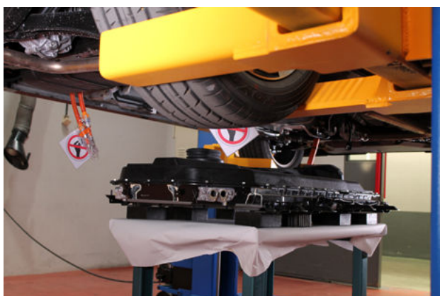
Ilustración 3: Ubicación de la batería de alta tensión en un vehículo Nissan e-Nv200
