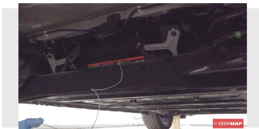
Ilustración 20: Registro de temperatura con sonda termopar
