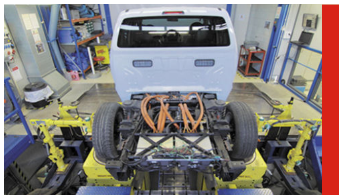
Ilustración 6: Prueba de vibración. Fuente: Autofácil
