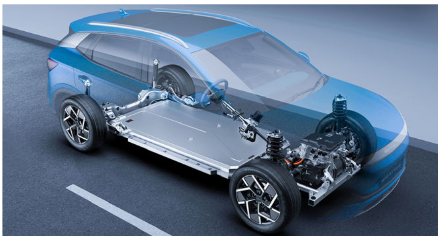
Plataforma para vehículo eléctrico e-Platform 3.0 de BYD, en el Atto 3 (Fuente: Prensa BYD)
