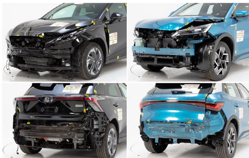
Comparativa de daños tras los crash tests CESVIMAP a los vehículos MG4 y Atto 3. Fuente: CESVIMAP
